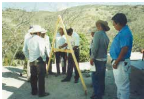
Figura 12.2 Arriba: taller sobre construcción y nivelación del aparato “A”. Abajo: uso del aparato “A” para el trazo de curvas a nivel en tierras de labor (Fuente: GVG, 2016).
