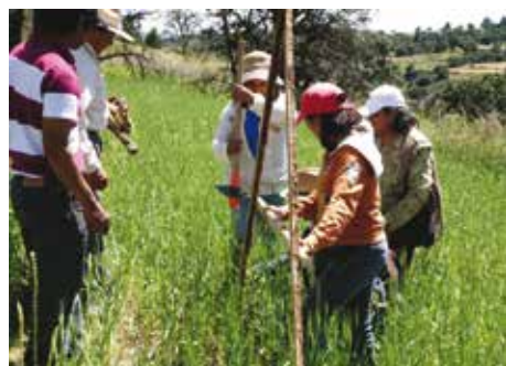
Figura 12.2 Arriba: taller sobre construcción y nivelación del aparato “A”. Abajo: uso del aparato “A” para el trazo de curvas a nivel en tierras de labor (Fuente: GVG, 2016).
